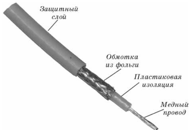
Рис. 4.1. Коаксиальный кабель
